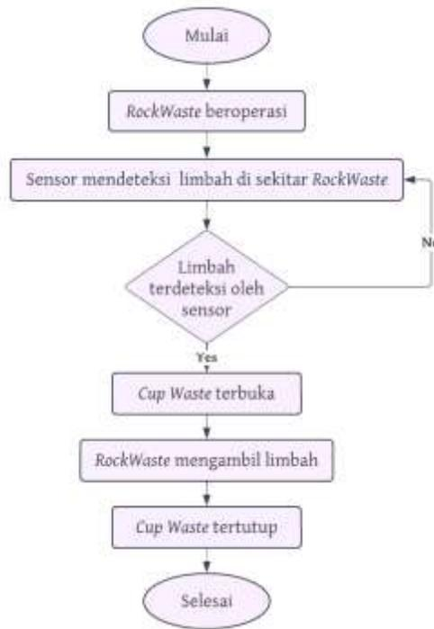
**Gambar 2.** Flowchart Sistem *RockWaste*
