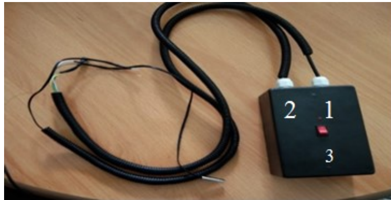
Gambar 3. Alat monitoring kekeruhan dan temperatur larutan nutrisi.
