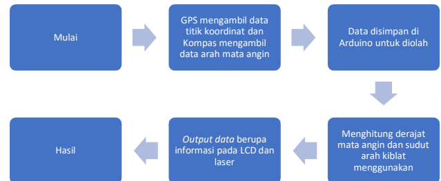
Gambar 2. Prinsip Kerja Alat Penentu Arah Kiblat
