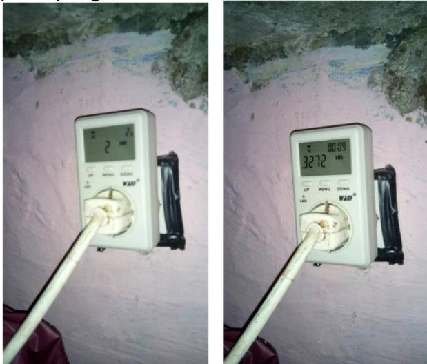
**Gambar 6.** Hasil pembacaan data energi oleh kWh-meter pada pompa dengan saklar sensor
