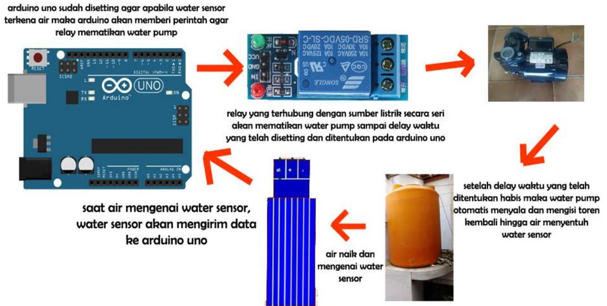
**Gambar 2.** Bagan cara kerja pompa air otomatis dengan sensor air
