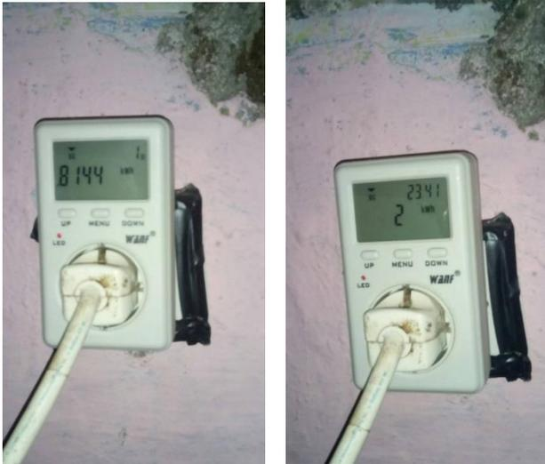
**Gambar 5.** Hasil pembacaan data energi oleh kWh-meter pada pompa dengan saklar pelampung
