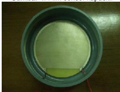
Gambar 5. Sensor kapasitif beserta wadahnya
