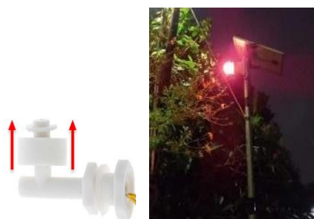
Gambar 9. Pelampung pada sensor water level float dinaikkan secara manual (kiri) dan lampu strobo menyala ketika pelampung sensor dinaikkan secara manual (kanan)
