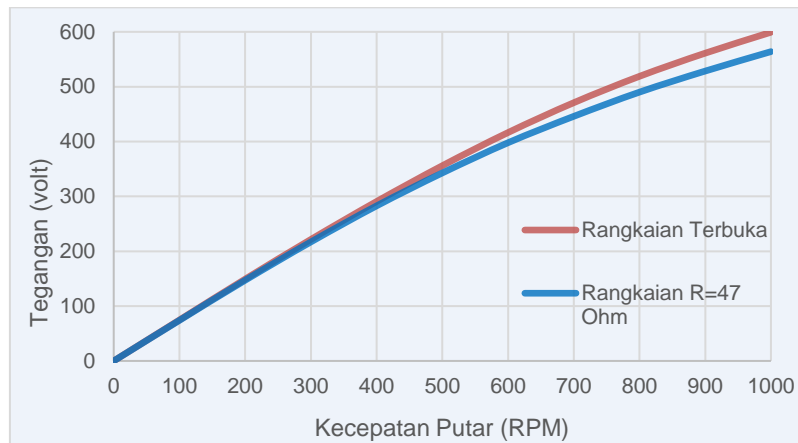
Gambar 4. Grafik hubungan nilai tegangan keluaran generator terhadap kecepatan putar generator
