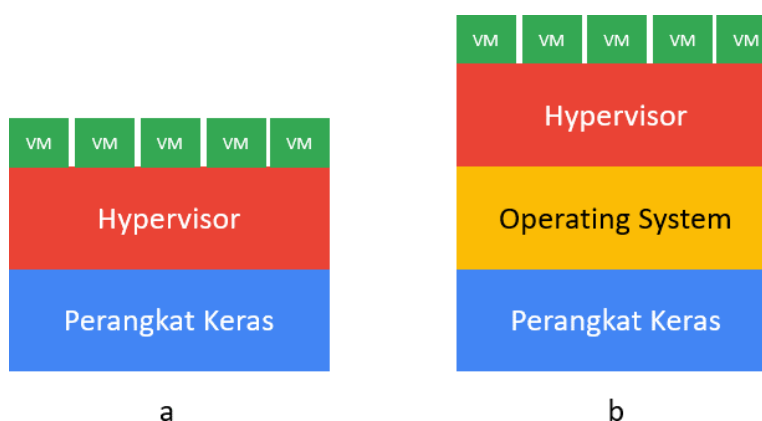
Gambar 1. Perbandingan Arsitektur Hypervisor tipe 1 (a) dan 2 (b)
